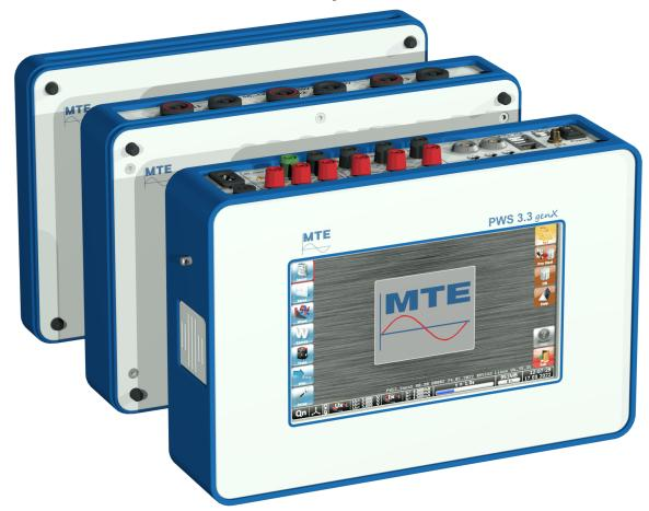
El PWS 3.3 genX es una combinación de un patrón de referencia trifásico de clase 0.05% y de un analizador de calidad de redes compatible según IEC 61000-4-30 Clase A con 4 canales de tensiones (U1, U2, U3, UN, UPE) y 4 canales de corriente (directa: 11, 12, 13 y vía Pinzas de corriente: corriente de Neutro IN o corriente de Protección a Tierra IPE).
