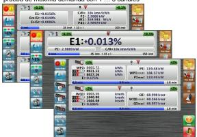
Control de la Instalación con valores de carga, diagrama vectorial, armónicos y visualización de forma de onda.
